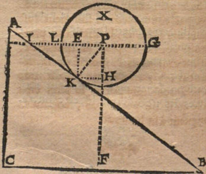
Faisant monter la sphere X par le plan incliné AB, souûtenant avec la main le point G, la partie de la pesanteur de X que je ressens, n'est que la moitié de celle qui porte sur le plan AB. Si BA longueur de ce plan est double de AC sa hauteur, puisque pour l'élever à cette hauteur il luy faut faire deux fois plus de chemin, sçavoir la longueur BA, qui est deux fois plus grande que AC, & par consequent employer plus de temps.
