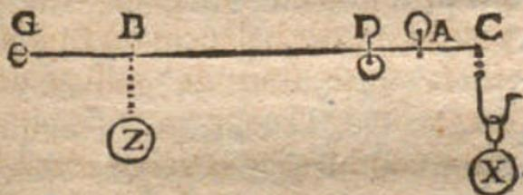
La Romaine est un levier, comme la figure le fait assez connoître. Cette Machine a cet avantage sur la balance qu'avec un poids d'une livre on peut mesurer la pesanteur d'un corps fort pesant; car par exemple quoy que le poids Z ne soit que d'une livre, il tiendra en équilibre le corps X qui est de 20. livres, par la 6. Propos.
