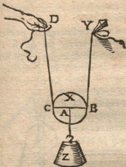
Mais il y a une espece de poulies qu'on appelle Mouffles ou Palans, par le moyen desquelles l'on peut avec une tres-petite force enlever un fardeau quelque pesant qu'il soit. X est une poulie de cette espece; z est un poids attaché au point A centre de cette poulie: YBCD est une corde dont une des extremittez est attachée
