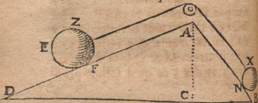
prouver que l'autre partie M de la pesanteur de X est égale à Q partie de la pesanteur de Z qui porte en l'air. Ce qui estant, lorsque ces deux corps seront joints par une corde, comme la figure le montre, ils doivent demeurer en équilibre: car ces deux corps n'agissent l'un contre l'autre, X contre Z, que par la pesanteur M, & Z contre X par la pesanteur Q.
