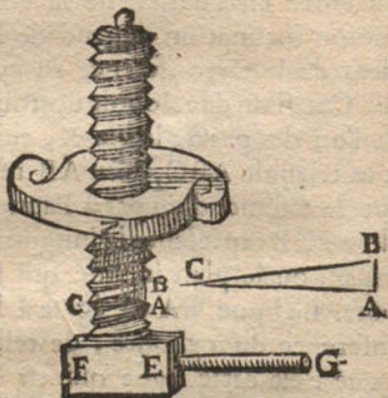
taillez pour la recevoir ; de sorte que lorsqu'on fait tourner les écroux on fait monter la viz ; & au contraire en faisant tourner la viz on fait monter les écroux, sur lesquels ayant mis
