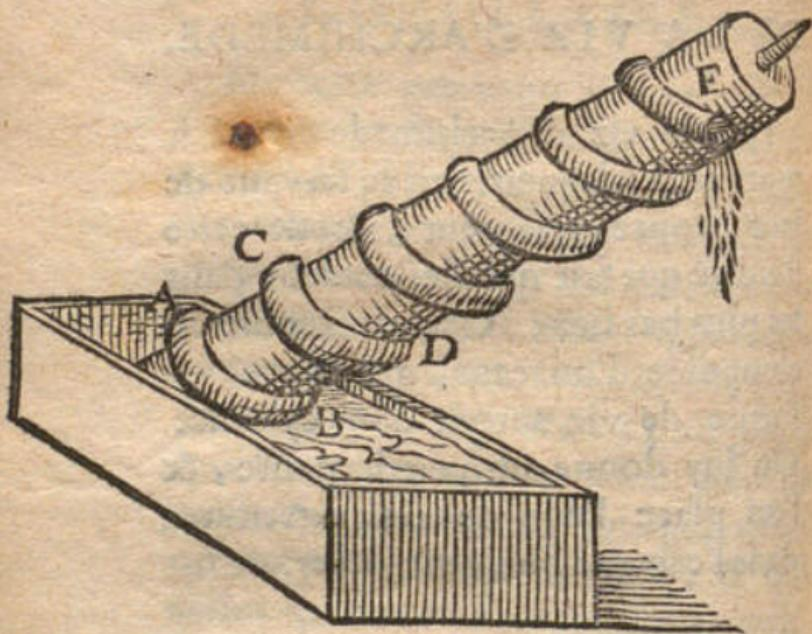
L'eau qui est entrée dans le canal par son ouverture A, doit couler en B qui est plus bas que A, en faisant tourner cette machine la partie B monte, & la partie C descend & se trouve plus basse, ainsi l'eau coulera de B en C. Lorsque la machine continuëra de tourner, la partie C se trouvant dessus & la partie D dessous, l'eau coulera de C en D, ainsi elle montera
