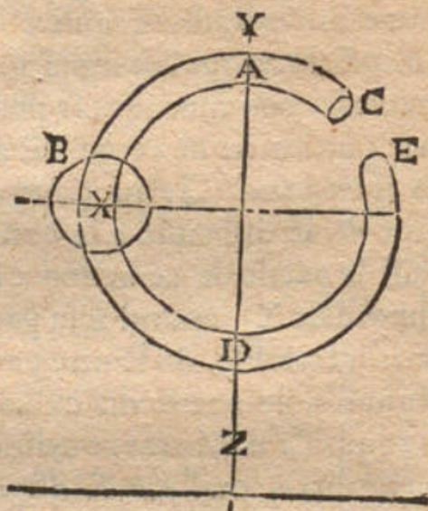
L'Anneau C, A, B, D, E, qui est coupé comme la figure le représente, est suspendu par sa partie A au point Y immobile. YZ est une perpendiculaire sur la terre. Cet Anneau se dispose de telle maniere, qu'il y en a une partie de l'autre côté de la ligne AZ qui demeure en équilibre avec ce qui est de l'autre côté; par conséquent il faut que la partie DE de cet An-
