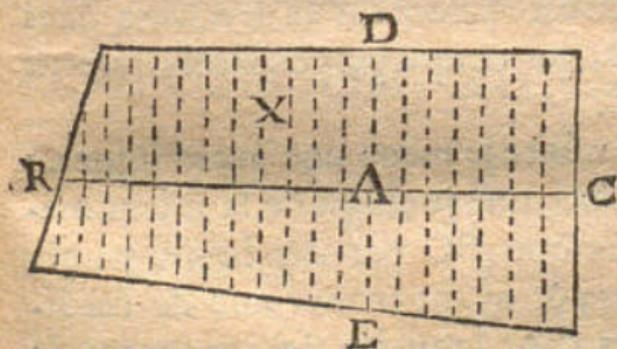
Soit la surface z dont il faut trouver le centre de pesanteur , je mene au hazard une ligne droite telle qu'est BC, que je coupe directement par des lignes paralleles. Je suppose que
