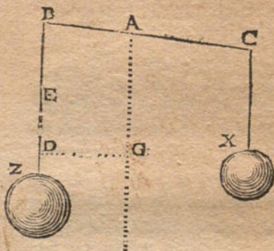
C'est pourquoy on doit mesurer la distance qui est entre un poids suspendu à une verge, & le point d'arrest par lequel cette verge est arrêtée, par une ligne perpendiculaire tirée de ce poids sur la ligne AG. Pendant que le poids Z sera dans la ligne ED parallèle à la ligne AG, sa distance du point d'arrest doit estre toujours considérée comme la même,
