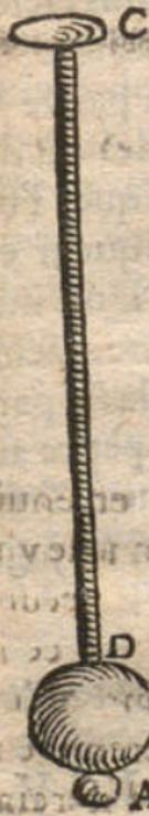
C D est un petit canal de verre, au bas duquel il y a deux bouteilles, dans la plus petite A il y a un peu de vif argent. La bouteille B qui est plus grosse est pleine d'un air fort rarefié; car une partie de cet air s'est retirée lors qu'on a approché du feu de la lampe la partie C de ce canal pour la fermer.
