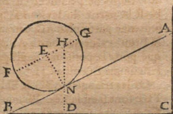
Lorsque la sphere X est tirée par une corde parallele au plan AB, l'on peut considerer que la force ou le pesanteur de cette sphere est ramassée dans la ligne ou le levier FG, parallele au plan AB.
