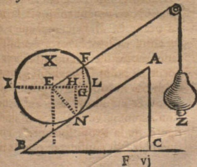
X est une sphere tirée le long du plan AB par la corde FO parallele à ce plan. Ainsi la puissance qui retient cette sphere est appliquée au point F. La ligne IL est une ligne horizontale. Par le 10. Lemme la distance de la puissance qui retient X, de E centre de pesanteur est EG, & H est la partie du levier IL qui est soutenue par le plan AB, partant par la Prop. 17. ce que porte AB est à ce que porte la puissance appliquée en F, comme EG est à EH.
