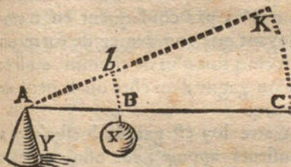
Soit AC un levier de la seconde espece, A est le point fixe, B est le centre de pesanteur du levier auquel est attaché un fardeau. Il a été démontré que si AB est à BC comme 1 est à 4, & que le fardeau qui est attaché à B soit de 500 livres, l'appuy A supportera 400. livres, & C n'en portera que 100. livres. Si on fait mouvoir ce levier AC, son extrémité A demeurant toujours sur son appuy Y, l'autre extrémité C décrira l'arc CK, & son centre B décrira l'arc B**b**.
