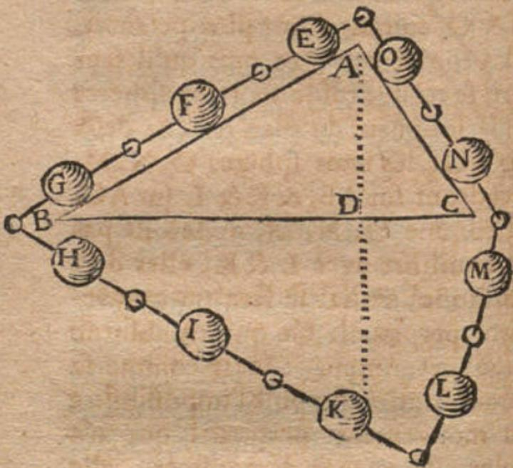
trois fois plus long que le plan AC. On place sur ces plans les spheres E, F, G, toutes égales, & qui se tiennent les unes aux autres comme les grains d'un chapelet. Il doit y en avoir trois sur AB, & deux sur AC. La pesanteur des trois spheres E, F, G, est à celle des deux spheres N & O, comme AB est à AC. Or dit cet Auteur, si les trois spheres E, F, G, ne demeurent
