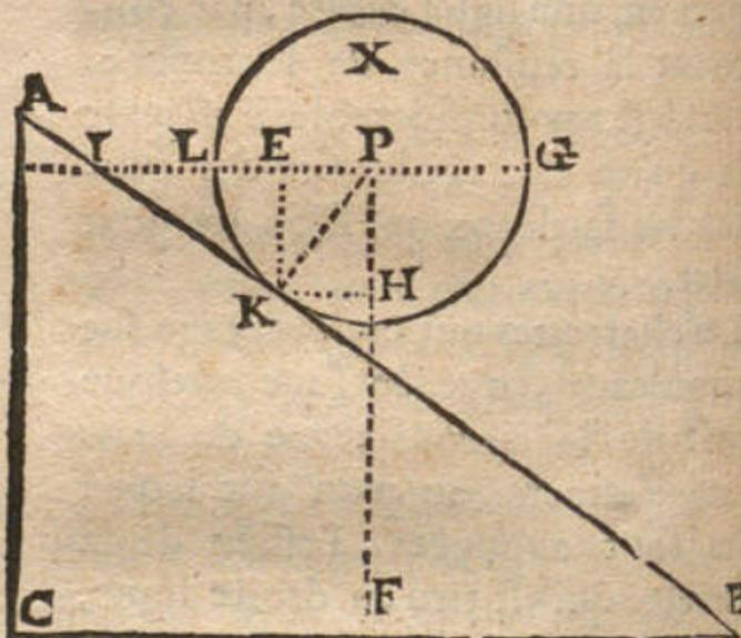
AB est un plan sur lequel est posée la sphere X qui touche ce plan au point K. La ligne par laquelle le centre de pesanteur de X tend en-bas est PH. Je dis que la distance de K au centre de pesanteur qui est P, se doit mesurer par la ligne KH ou son égale PE; car les corps tendant vers la terre par une ligne perpendiculaire, ils pressent selon
