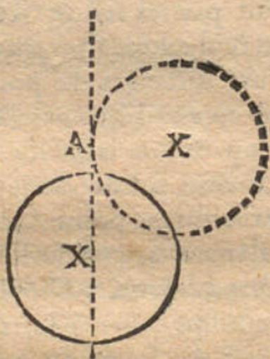
Nous avons dit que le centre de pesanteur se trouve dehors ou dedans un solide; car par exemple dans un Anneau comme est X, il ne peut être que dans le milieu. Si on ne le suspend par le point A, pourvû que son centre soit dans la ligne de direction, il demeurera bien en équilibre, ses
