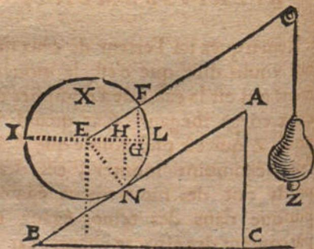
Car si en faisant monter X le long du plan AB, l'on diminuë la resistance du fardeau à proportion de l'inclination de ce plan, c'est à dire à proportion que la ligne BC est plus ou moins grande. Aussi pour élever ce fardeau de la hauteur de AC, il le faut faire venir de plus loing, sçavoir de B. Ainsi comme plus cette ligne BC est grande, moins on ressent la pesanteur de X, aussi il faut mettre plus de temps, & le faire venir de plus loing.
