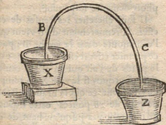
On appelle Syphon un canal recourbé qui a deux jambes. Si on plonge celle qui est la plus courte dans X un vaisseau plein de quelque liqueur, l'expérience fait connoître qu'ayant commencé à attirer cette liqueur en suçant par l'ouverture de la plus grande jambe, elle s'écoulera en suite d'elle même par cette ouverture dans le vase Z, jusqu'à ce que
