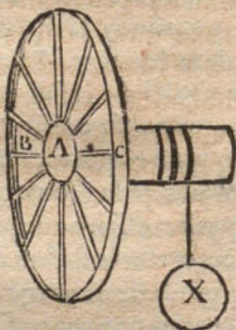
On perpetuë en quelque maniere la force du levier par le moyen d'une roüe. Soit la roüe Z composée de plusieurs rayons. Cette roüe a un axe assez gros dont BA est le rayon ; on vuide au tour de cet axe une corde d'où pend le fardeau X, lequel on veut enlever. Il est évident que BC est un veritable levier dont A est l'appuy ; Donc une force appliquée en C tiendra en équilibre le fardeau X,
