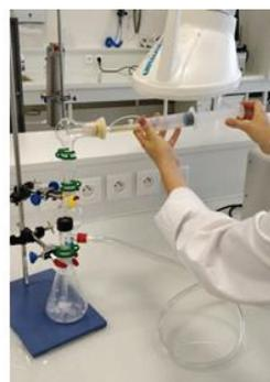
*OPTION : Pour plus de précision, les 7 mL de la chambre haute peuvent être placés dans une fiole jaugée de 10 mL et complétés à l'eau D.I et les 30 mL de la chambre basse peuvent être placés dans une fiole jaugée de 50 mL et complétés à l'eau D.I.*
